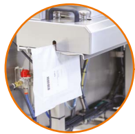
La bolsa etiquetada se sella automáticamente y queda lista para el envío.
